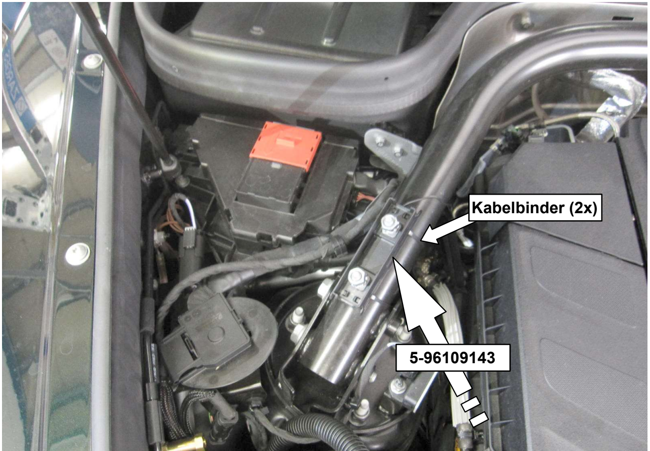
26 Sicherungshalter einbauen! / Mount the fuse holder!
