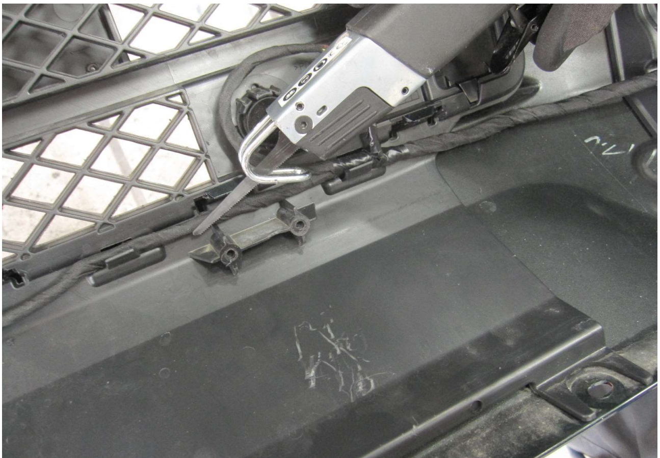
31 Halter entfernen! / Cut off the holder!
